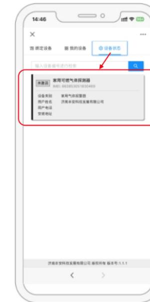
此时,探测器上线、掉电、报警、故障及状态恢复信息可及时推送至公众号,点击“设备状态”可查询探测器最近一次上传的浓度值,实时查询设备的运行状态。
